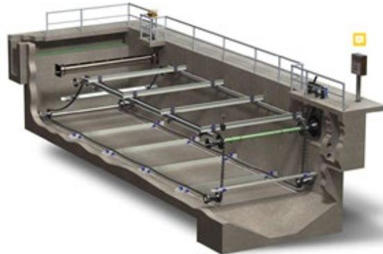
Figura 38. Sistema colector de lodos de cadena sumergida
