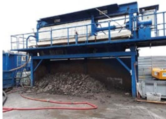
Figura 39. Sistema de deshidratación Filtros Prensa
